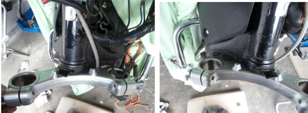
Anschließend die Mutter wieder etwas lösen  $\frac{1}{4}$  /  $\frac{1}{2}$  Umdrehung. Kann man auch ganz wieder lösen und anschließend mit sehr wenig Drehmoment wieder gegen ziehen (5-6Nm) Wer den Hakenschlüssel verwendet muss es nach Gefühl machen (leicht sehr leicht gegen ziehen !) Es gibt dafür sogar das Spezialwerkzeug das Besitze ich aber nicht.
