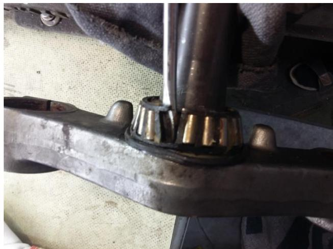
Die Staubschutzkappe, die unter dem Lager liegt, nun mit einer Zange oder ähnlichem Werkzeug entfernen.
