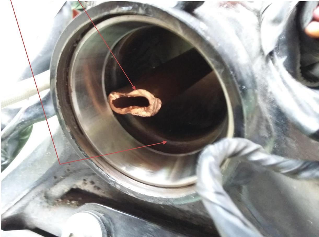
Sollte es mit dem Kupferrohr nix werden = Verwendet man für die ersten 3-4mm eine Brechstange (ringsum Hebeln, d.h. immer wieder den Hebel umsetzen und dabei nur minimal aushebeln. Die Schale darf nicht verkanten). **Funktionierte bis jetzt immer problemlos**
