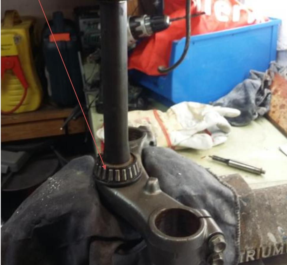
Unter dem Lager liegt noch eine Staubschutzkappe. Sollte das Lager noch Original sein einfach mit Schraubendreher den Käfig (ist aus Kunststoff) zerstören. Und die Rollen und den Käfig entfernen. (Man muss es nicht entfernen, nur geht die Staubschutzkappe sonst schlecht runter.)
