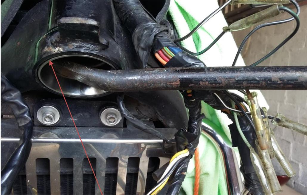
Ist der Untere Lagerring unten Bündig „Rausgehebelt“ ist der Rest leicht mit dem Kupferrohr auszutreiben.
