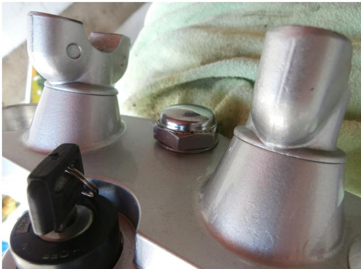
Dann den Lenker montieren und die „Reste“. Lenker immer noch nur provisorisch anziehen, ggf. muss man nach der Kontrolle der Leichtgängigkeit (siehe folgende Seite) da nochmal kurz an die SW30 Mutter.
