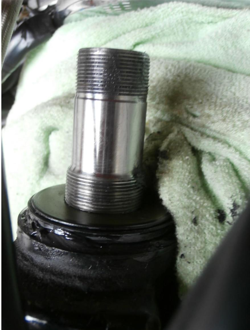
Die Original Schutzkappe aufsetzen und + Lenkschaftmutter (Richtigrum!) von Hand aufschrauben.
