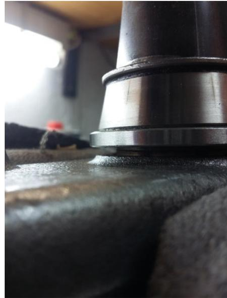
**Tip Werkzeug wechseln** und möglichst einen alten Großen Schlitzschraubendreher verwenden. Diesen nur seitlich zwischen Brücke und Lagerschale führen, so das der Schaft nicht beschädigt werden kann. Also ca. so (die Lagerschale so gut es geht dabei natürlich dann auch **Ringsum** mit leichten/mittleren Hammerschlägen weiter nach oben treiben.)
