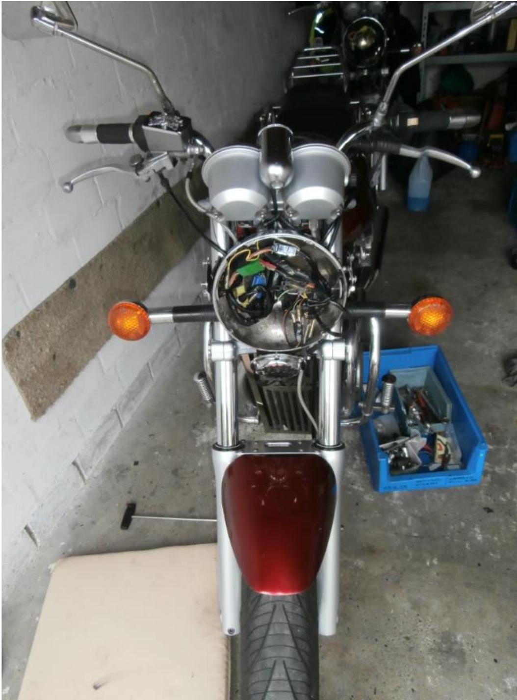
**Kontrolle der Leichtgängigkeit bzw. des Spiels:** Abschließend muss man die Leichtgängigkeit der Lenkung bzw. die Lenkerspannungseinstellung prüfen.
