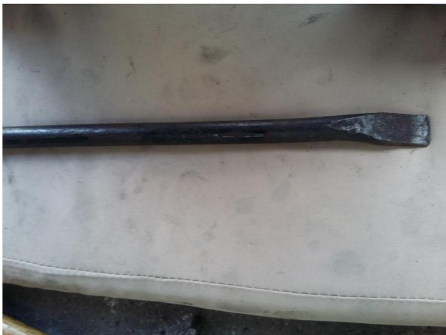
**Der obere Lagerring** lässt sich leicht austreiben. Hilfsmittel von unten nach oben durch die Bohrung und gegen die Kante der Lagerrings **ringsum**, d.h. ständig wechselnd (nicht nur auf eine Stelle Rumhämmern) mit leichten Hammerschlägen auf das Hilfsmittel austreiben. Hatte noch nie Kummer, den raus zu bekommen.
