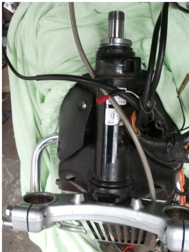
Nun ist der Lenkschaftkopf zu montieren. Die Bohrung fette ich leicht ein.
