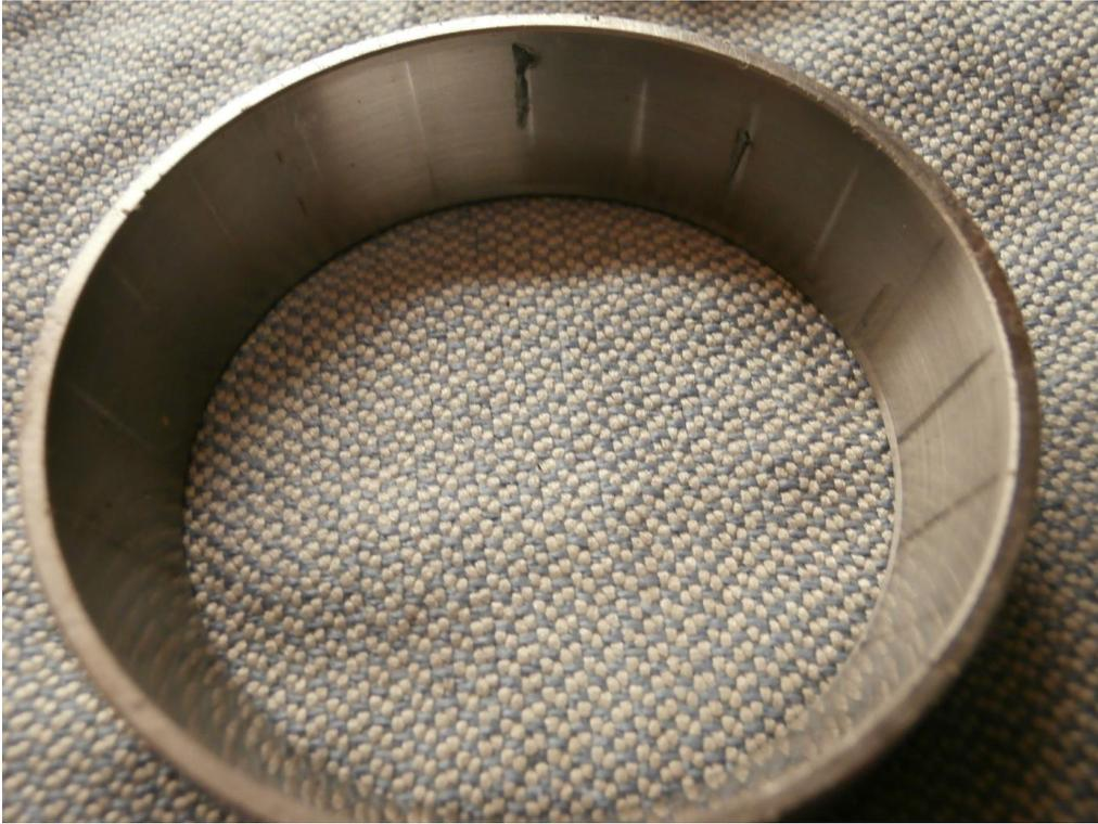
Rost Korrosion (obere Lagerschale schon ausgebaut + sauber)
