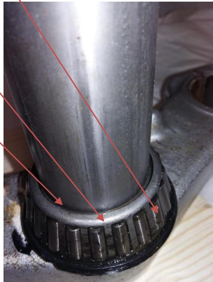
Hier ist es nun einfach Druck auszuüben. Natürlich kann man auch mit dem Hammer arbeiten. Leichte Schläge auf das Rohr oben und die Sache funktioniert problemlos. Da darf ruhig zum 500Gramm Hammer gegriffen werden.
