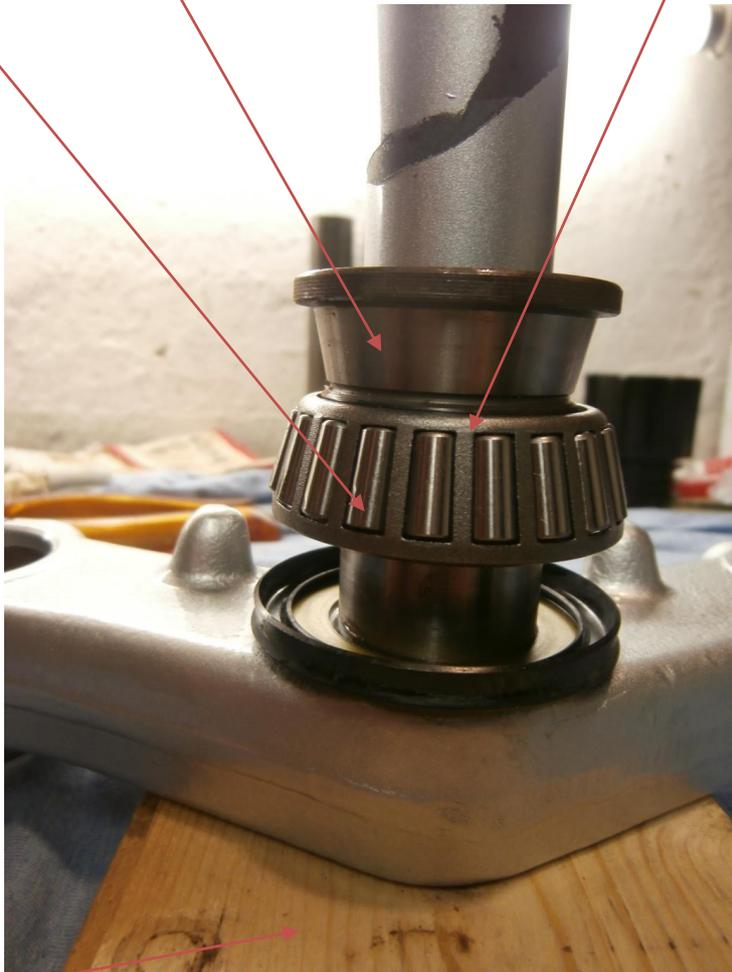
**Ein Holz** als Unterlage ist hilfreich. Sonst kibbelt die Sache etwas. Die Bohrungen für die Standrohre sind dicker. Dadurch liegt das Teil nicht gleichmäßig auf.
