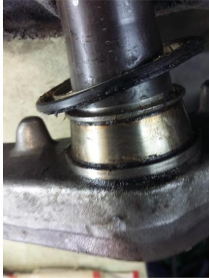
Mit einem gut geschliffenen, möglichst breiten Meißel **ringsum**, also **ständig wechselnd** zwischen Lagerring und unterer Brücke leichte / mittlere Hammerschläge (Keine Kräftigen Hammerschläge) einbringen, so das die Lagerschale sich nach oben bewegen muss. (Hatte ich noch nie Kummer mit)
