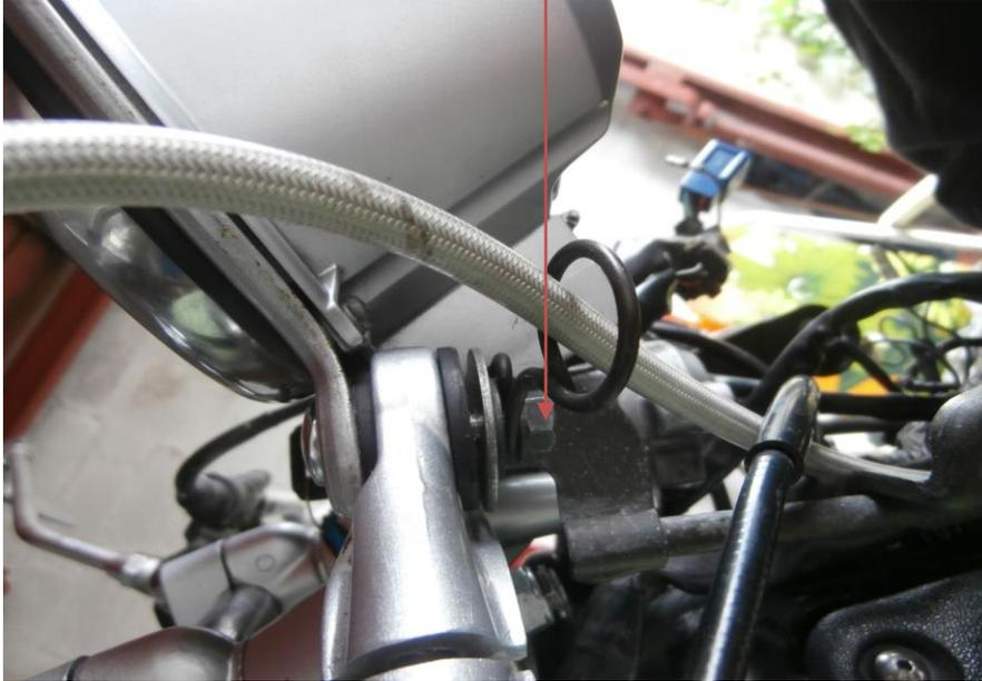
Lenker lösen (Kappen entfernen und die 4 Innensechskantschrauben SW 6 lösen. Tank mit einem Handtuch oder Decke schützen und Lenker dort ablegen .
