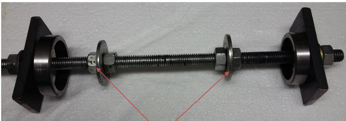
Zusätzliche Zentrierhilfen in Form Von Scheiben. (Fixiert mit Muttern) Durchmesser der Scheiben = 39 bis 40 mm. Der Obere Lagerring hat innen ca. 38 mm Der Untere knapp 45mm Die Bohrung im Lenkkopf etwas über 40mm. Muss dann natürlich von Unten eingeführt werden! **Großer Vorteil dabei** = Das Werkzeug liegt besser und genauer Zentriert in der Bohrung des Lenkkopfes. Ein verkannten oder schiefes einziehen der Lagerringe ist damit wesentlich unwahrscheinlicher 😊
