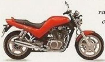
*Le charme discret que dégage la VX 800 n'a pas d'égal, classicisme oblige. En effet, bon nombre d'atouts dont elle ne fait pas état sont pourtant là. Comme l'embrayage muni d'un système de rampe hélicoïdale qui évite le blocage de la roue aux décélérations et le patinage de la roue arrière lors des accélérations trop brutales.*
